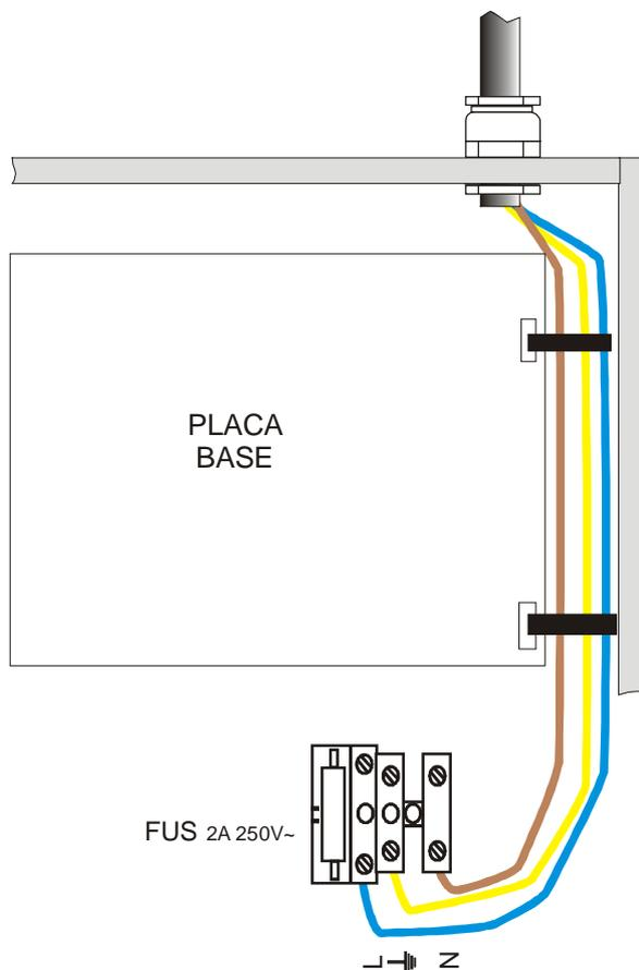
La alimentación de los equipos de control de incendios deberá disponer de un diferencial de protección independiente con un fusible de protección de 230Vca / 5A o superior. La sección de cableado de alimentación no será inferior a 0,75 mm<sup>2</sup>.
