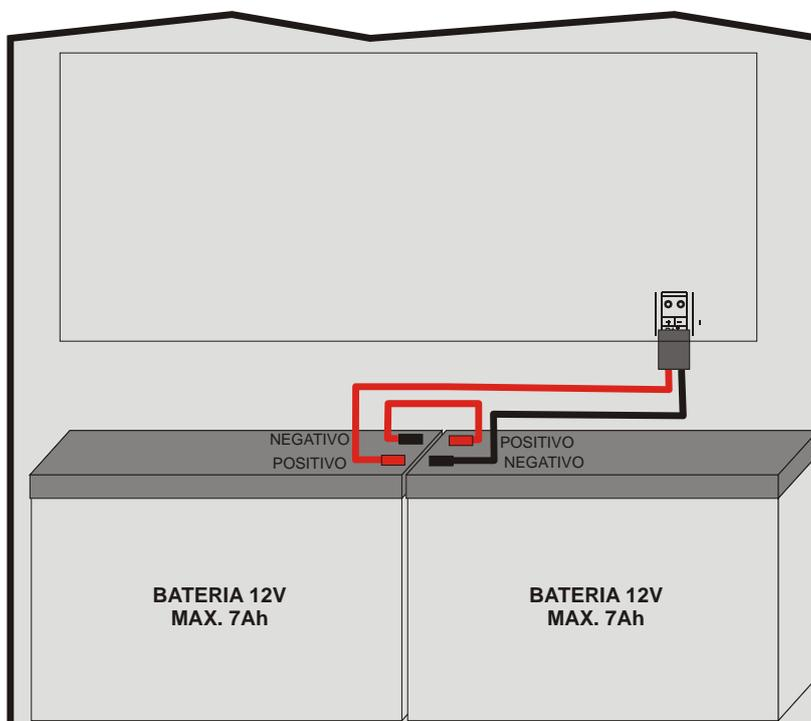
En la caja se incluye un cable de conexión para las baterías, conectado en la placa base. El conector rojo (positivo) debe conectarse al terminal positivo de la batería 1, y el conector negro (negativo) al terminal negativo de la batería 2.
