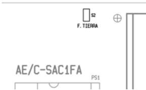
La supervisión de fallo de tierra debe estar habilitada durante el funcionamiento normal del sistema. La conexión de equipos en los puertos de comunicaciones RS-232 y RS-485 puede provocar la indicación de Fallo de Tierra, si dichos equipos tiene unificado el negativo de las comunicaciones con la Tierra de dicho equipo.
