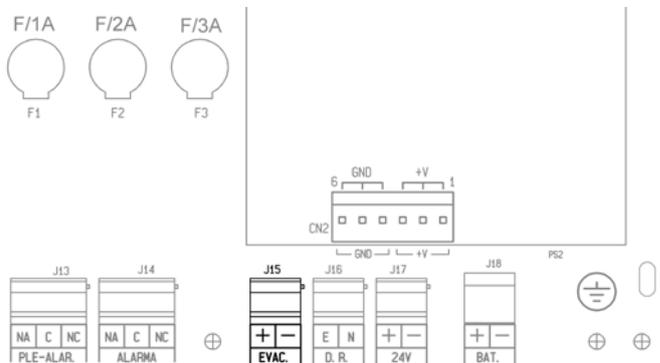
La conexión en la salida de Evacuación Local se realiza en la placa base en el conector J15 mediante 2 hilos. Las diferentes sirenas o campanas de evacuación se conectan en paralelo y con una resistencia de final de línea de 2K7.
