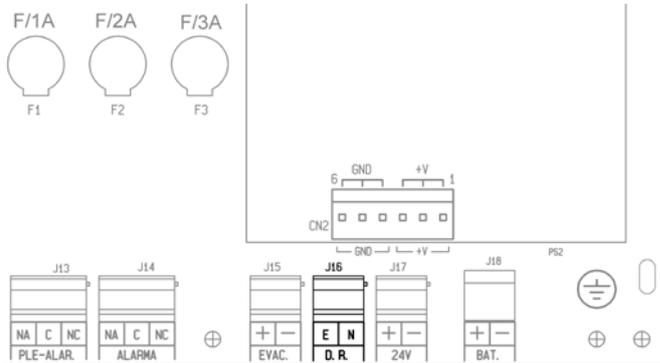
Para realizar la desconexión remota del equipo, unir los terminales E y N.
