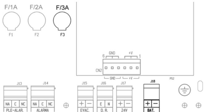
Una vez terminada la conexión de las baterías, el conector enchufable polarizado debe ponerse en J18.
