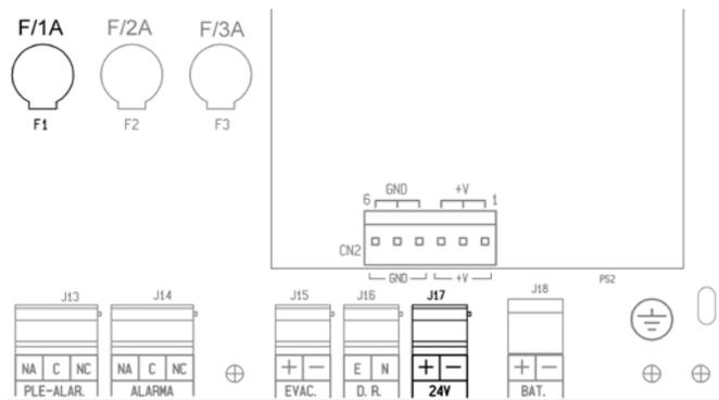
El equipo dispone de una salida auxiliar polarizada de 24V en el conector J17.
